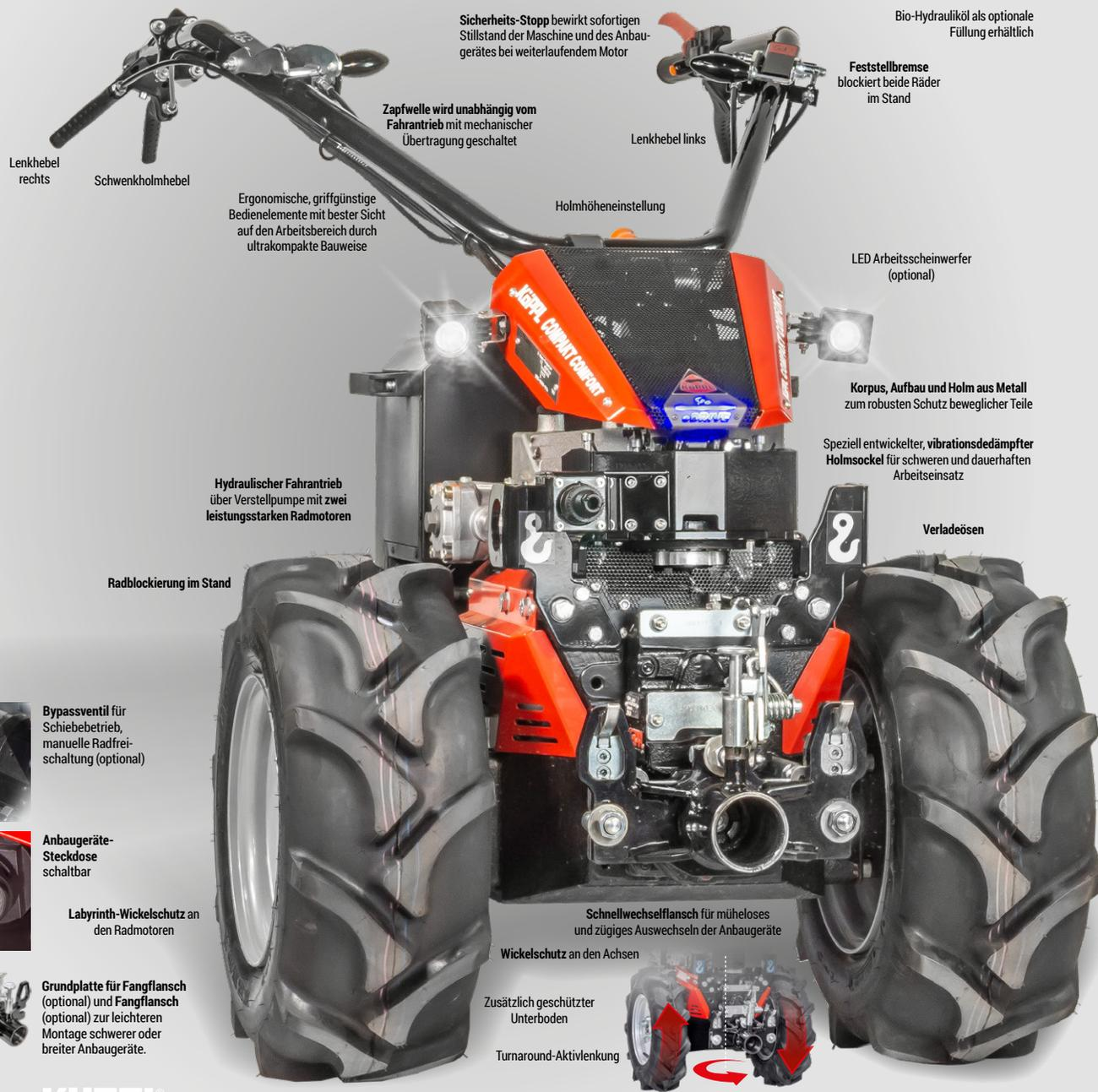
**Sicherheits-Stopp** bewirkt sofortigen Stillstand der Maschine und des Anbaugerätes bei weiterlaufendem Motor
